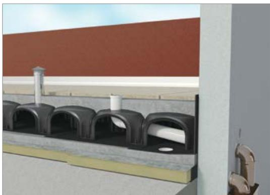
Spaccato di un tetto piano ventilato con Iglu<sup>®</sup> ventilated roof
