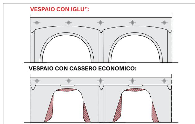
L'Iglu'® viene prodotto rispettando elevati standard qualitativi; non subisce, durante e dopo il getto, le pericolose deformazioni dovute al peso del calcestruzzo ed all'effetto dinamico delle operazioni di lavorazione: carico del calcestruzzo fresco, spinte di costipamento e vibrazione del getto, peso delle persone e delle attrezzature assicurando le geometrie del vespaio ed il reale consumo di calcestruzzo.
