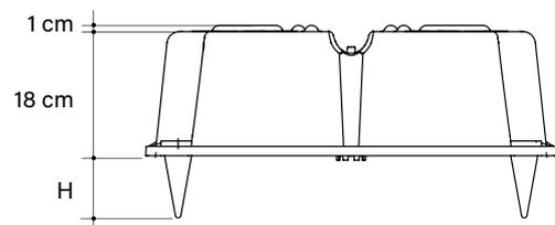
Изображения только для примера: прокладки арматуры могут иметь разные формы и положения. Вторичный материал допускается с допуском размера  $\pm 1,5\%$ .
