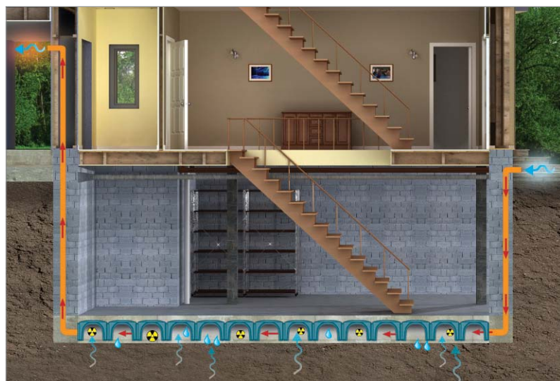
Dom wybudowany przy wykorzystaniu fundamentu wentylowanego IGLU®.
