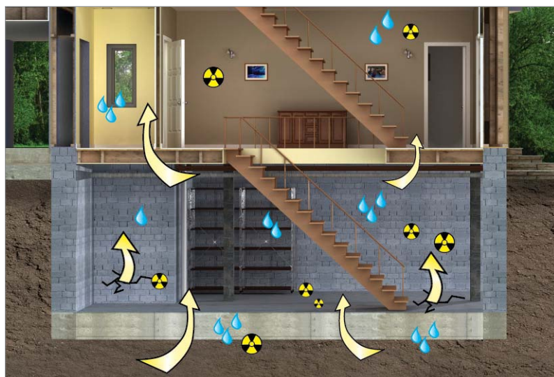
Zagrożenie wywołane obecnością radonu i wzrastającą wilgotnością w domu budowanym na tradycyjnym fundamencie.
