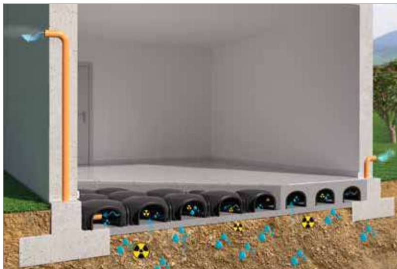
Habitation construite avec une fondation ventilée IGLU®.
