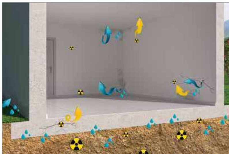
Danger du gaz Radon et de l'humidité ascensionnelle à l'intérieur d'une habitation construite avec une fondation traditionnelle.
