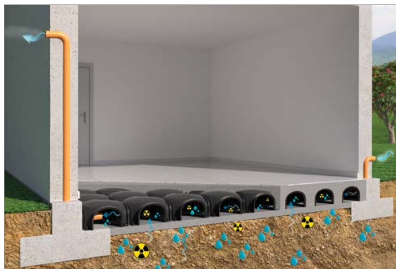
Vivienda construida con unos cimientos ventilados IGLU®.
