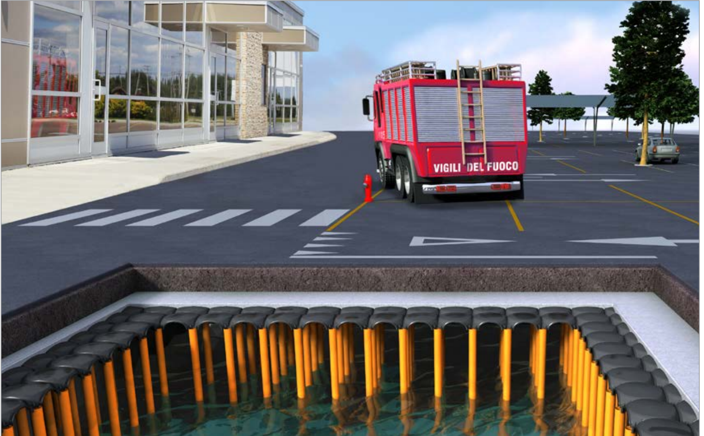
Bir yangın söndürme sistemi olarak depolama tankı
