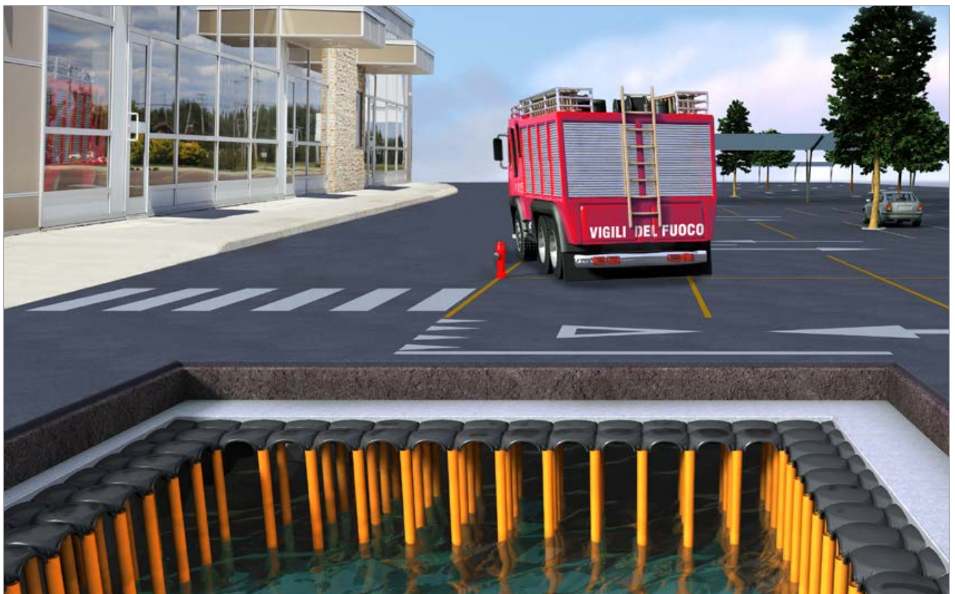
Für eine Löschanlage nutzbares Sammelbecken
