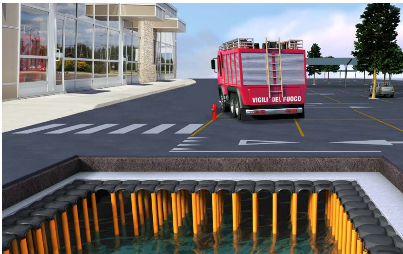
Uppsamlings tank som används som brandsläckningssystem
