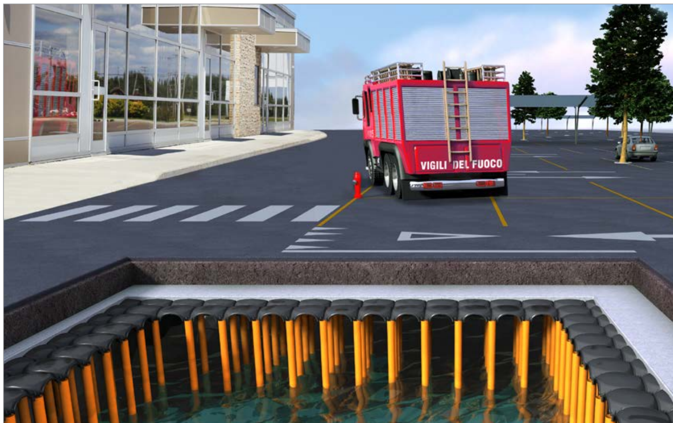
Zbiornik używany w systemie ochrony przeciwpożarowej
