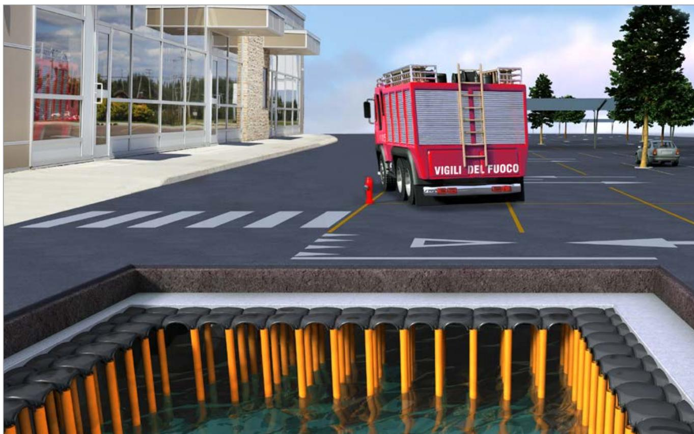
Exemple d'application. Bassin de rétention à utiliser comme installation contre l'incendie dans un centre commercial.
