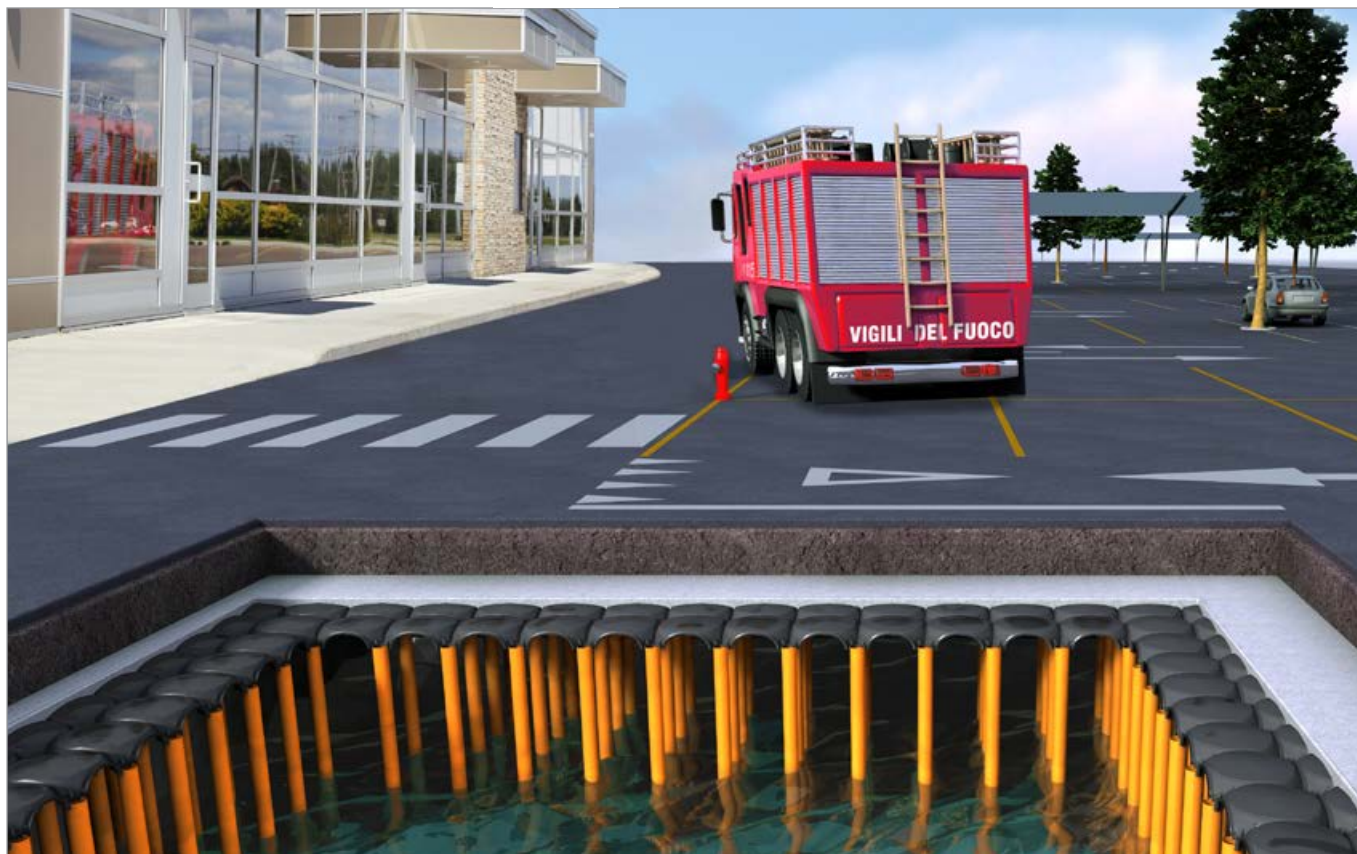
Сборочный бассейн, используемый в качестве противопожарной системы
