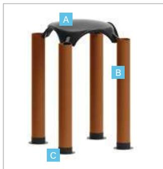
En configuration standard, le Système Atlantis est composé de trois éléments de base: coffrage Atlantis h 16 cm (A), tube (B) diamètre 110 mm (externe) et hauteur variable, pied (C) d'ancrage. Pour la occlusion latéral des coffrages accolés à la paroi, c'est utilisé **Tympan accessoire**.
