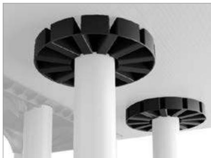
La Bride est un accessoire avec renforcement à la fonction de compensation. L'accessoire est en PP recyclé (Alaplen®) et est disponible pour toutes les tailles du Système Atlantis: 50x50 cm; 71x71 et 100x100, mais seulement avec le tube de Ø 110 mm.
