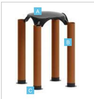
En la configuración estándar, el Sistema Atlantis está compuesto por tres elementos básicos: encofrado Atlantis h 16 cm (A), tubo (B) diámetro 110 mm (externo) y altura variable, pata (C).
