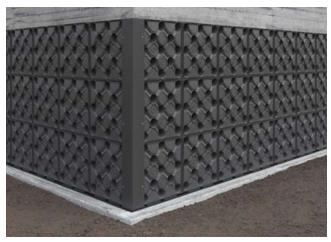
Den Eckabschluss zum Schutz des Hohlraums von Infiltrationen positionieren. Dann mit Schrauben oder chemischen Dübeln, die nicht länger als 3 cm sind, an der Iglu® Barrier befestigen (um Bohren der Abdichtung zu vermeiden).
