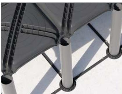
Der Spacer ist ein Zubehörteil, mit dem die Rechtwinkligkeit der Atlantis System-Rohre sichergestellt wird. Der Spacer besteht aus recyceltem PP (Alaplen®), das ist alle Größen des Atlantis-Systems erhältlich: cm 50x50 - 71x71 - 100x100. und kann nur mit dem UNIVERSAL-Fuß verwendet werden.
