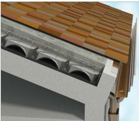
Risszeichnung eines mit Iglu® ventilated roof belüfteten Schrägdachs
