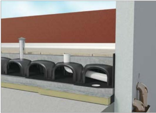
Risszeichnung eines mit Iglu® ventilated roof belüfteten Flachdachs
