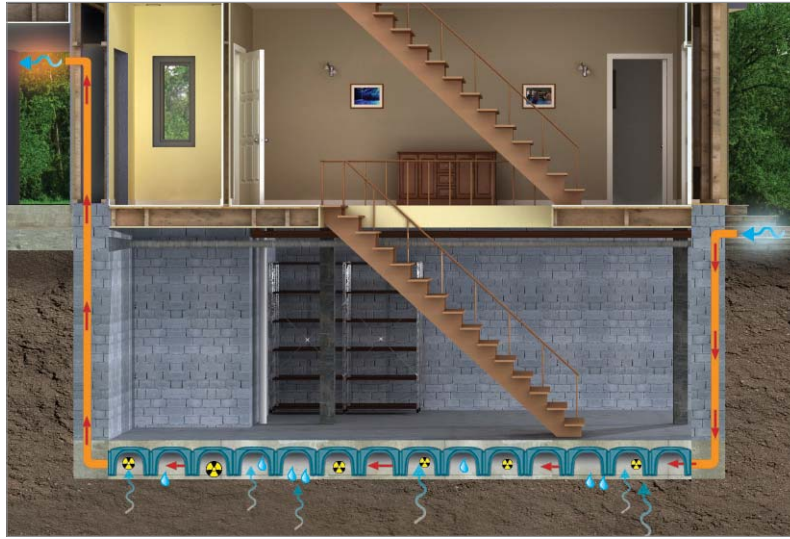
IGLU® temeli ile havalandırılan ev temeli.
