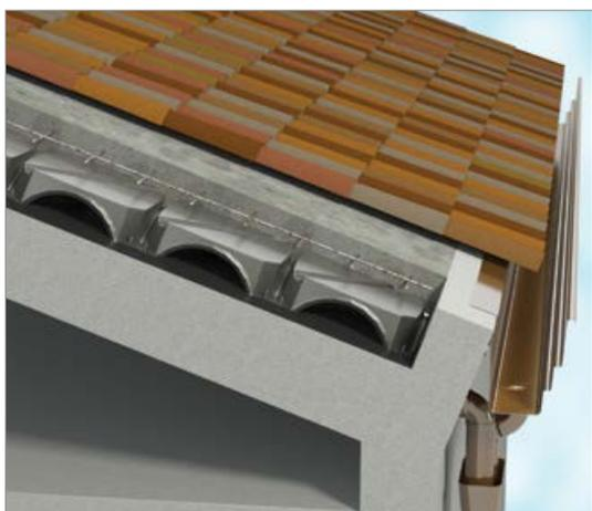
Разрез рифленой вентилируемой подвесной крыши от Iglu<sup>®</sup> ventilated roof
