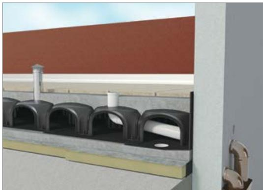
Разрез прямой вентилируемой крыши от Iglu<sup>®</sup> ventilated roof
