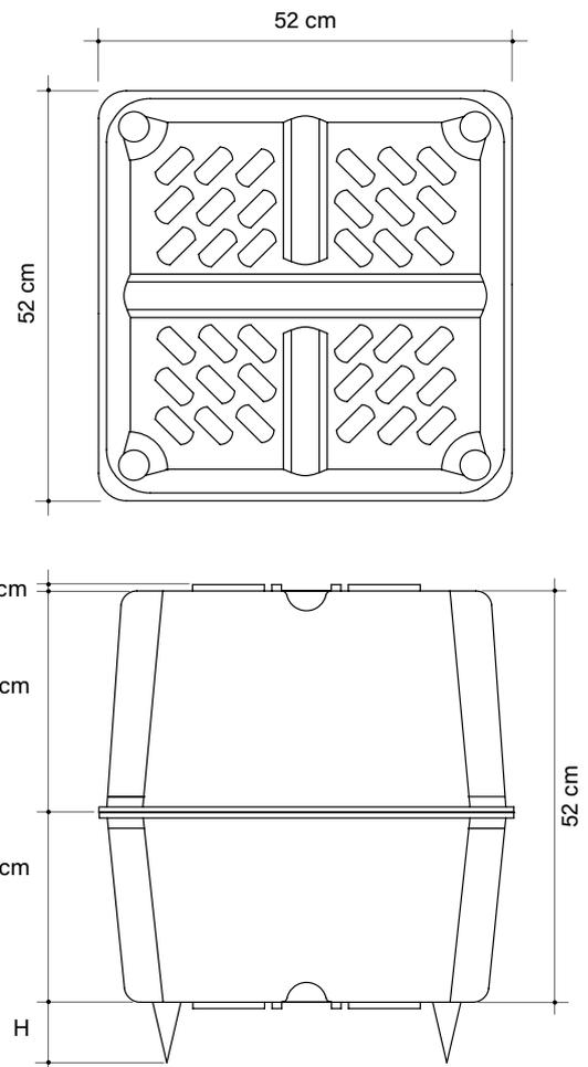
Die beiden Blockierstifte verleihen größeren Halt zwischen den beiden Hälften. Sie sind nach Wahl in die entsprechenden Sitze an zwei gegenüberliegenden Winkeln einzusetzen.
