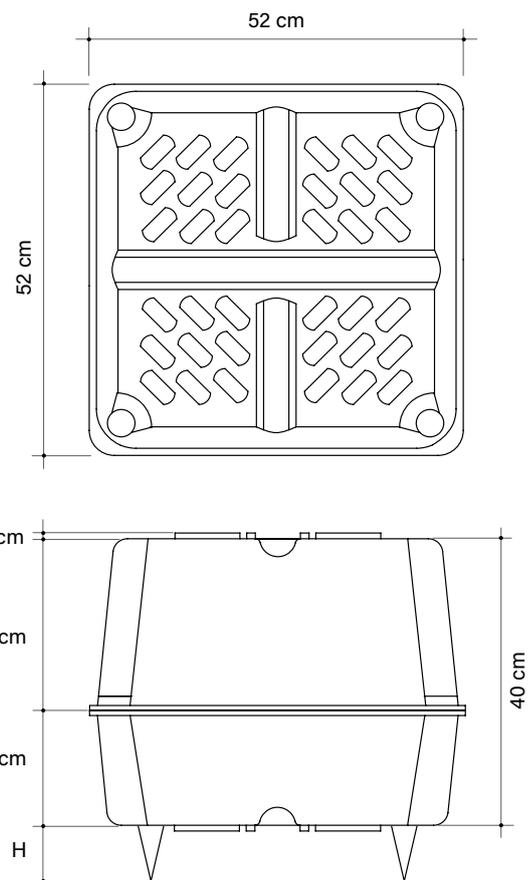
Die beiden Blockierstifte verleihen größeren Halt zwischen den beiden Hälften. Sie sind nach Wahl in die entsprechenden Sitze an zwei gegenüberliegenden Winkeln einzusetzen.
