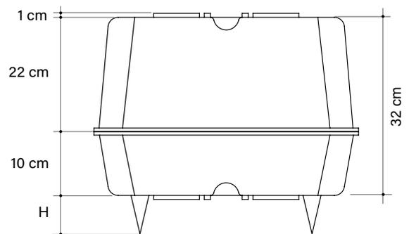
Die beiden Blockierstifte verleihen größeren Halt zwischen den beiden Hälften. Sie sind nach Wahl in die entsprechenden Sitze an zwei gegenüberliegenden Winkeln einzusetzen.
