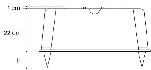
Las imágenes son solo a modo de ejemplo: los espaciadores de refuerzo pueden tener diferentes formas y posiciones. Tomando en consideración el material reciclado, se admite una tolerancia dimensional del  $\pm 1.5\%$
