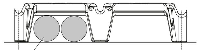
Passage de 2 tuyaux Ø 77 mm par tunnel
