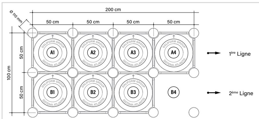
Le système doit être contreventé sur le périmètre afin de ne pas permettre des déplacements dans le plan horizontal.
