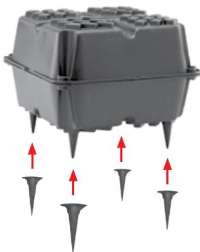
Pour déterminer l'épaisseur de la dalle d'intrados (Fig. 1 - H), en plus des pieds de 0 à 10 cm, sont disponibles les pieds élévateurs supplémentaires de hauteur variable de 11 à 20 cm: ces accessoires doivent être greffés sur ceux qui existent déjà.
