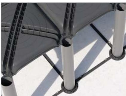
El Espaciador es un accesorio que se utiliza para asegurar la perpendicularidad de las tuberías del Sistema Atlantis. El accesorio está hecho de PP reciclado (Alaplen®), está disponible para todos los tamaños del Sistema Atlantis: cm 50x50 - 71x71 - 100x100 y solo se puede utilizar con la pata UNIVERSAL.
