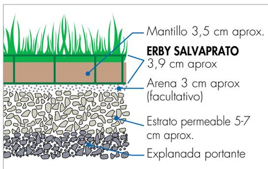
La comodidad del enganche, la levedad de las rejillas individuales, la modelabilidad en las varias formas (una simple sierra es suficiente) permiten una colocación rápida y eficaz de Protector de césped ERBY tanto para grandes, como pequeñas superficies. Preparado un substrato portante de acuerdo con la naturaleza del sitio y el uso previsto es necesario actuar como descrito a continuación:
