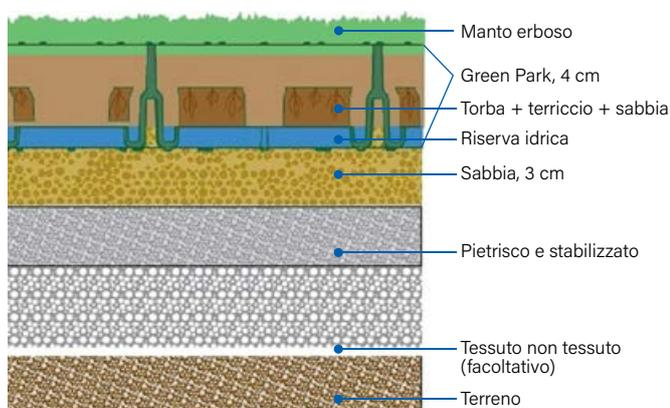
**1 PREPARAZIONE SOTTOFONDO DI TIPO STRADALE** con pietrisco e stabilizzato, ben livellato, rullato e compattato di spessore idoneo al transito veicolare.
