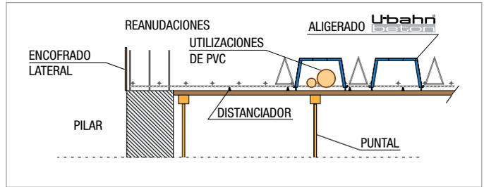
**2** Se colocan los encofrados U-Bahn<sup>®</sup> Beton disponiéndolos con la distancia entre ejes que se desea y que determinará el espesor de las vigas. Gracias a la pata cónica elevadora, los encofrados U-Bahn<sup>®</sup> Beton quedarán levantados de la superficie y permitirán formar la losa inferior. Se pondrán dentro de los huecos internos de los aligeramientos las instalaciones previstas.
