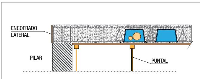
**5** Asegurado un nivel adecuado de fraguado, se podrá completar la colada volviendo a empezar por el punto de partida embiando completamente el U-Bahn<sup>®</sup> Beton. Por último se procederá a nivelar y a alisar la colada de la manera tradicional.
