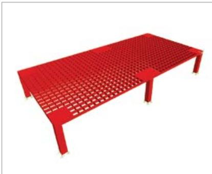
Modelado "shell+solid" estructura no deformada.
