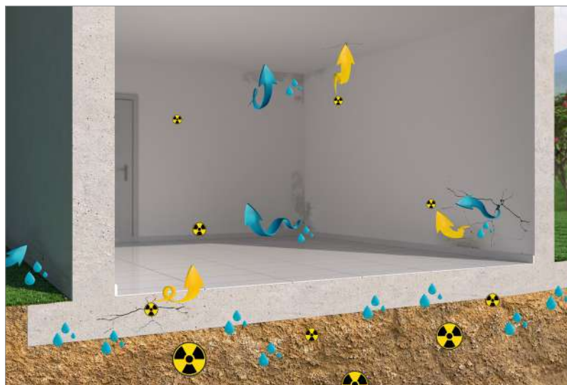
Gefahr durch Radon und aufsteigende Feuchtigkeit in einem Wohngebäude, das mit herkömmlichem Fundament konstruiert wurde.
