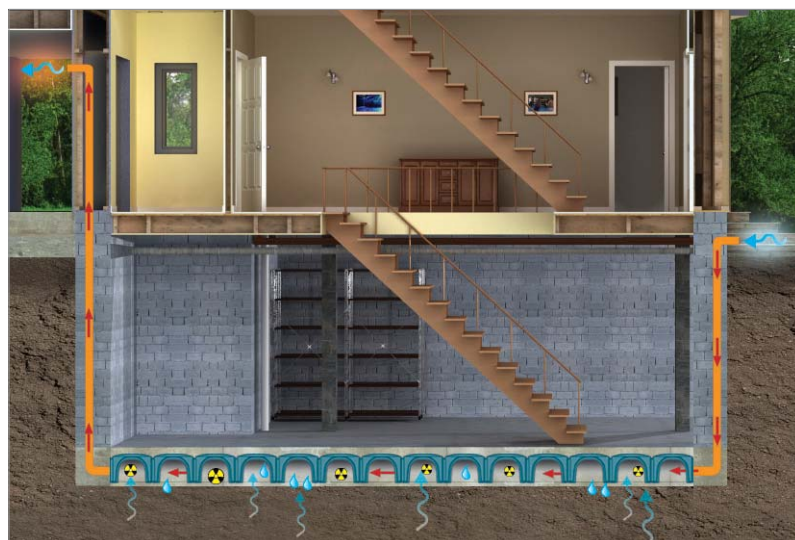
Здание, построенное с вентилируемым фундаментом IGLU®.
